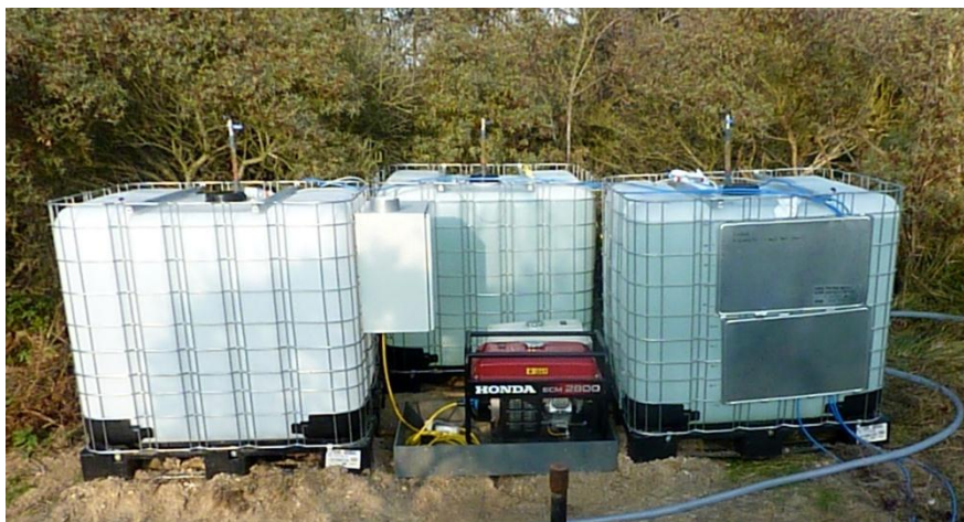
Figuur 2.7. De drie vaten van de doseerinstallaties, met boven de flowmeters voor het instellen van de doseersnelheid.
