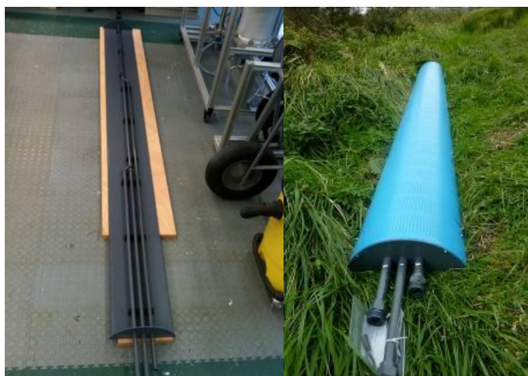
Figuur 2.6. De drie doseerbuisen in het doseerfilter, en het doseerfilter klaar voor gebruik vlak voordat het wordt geplaatst.
